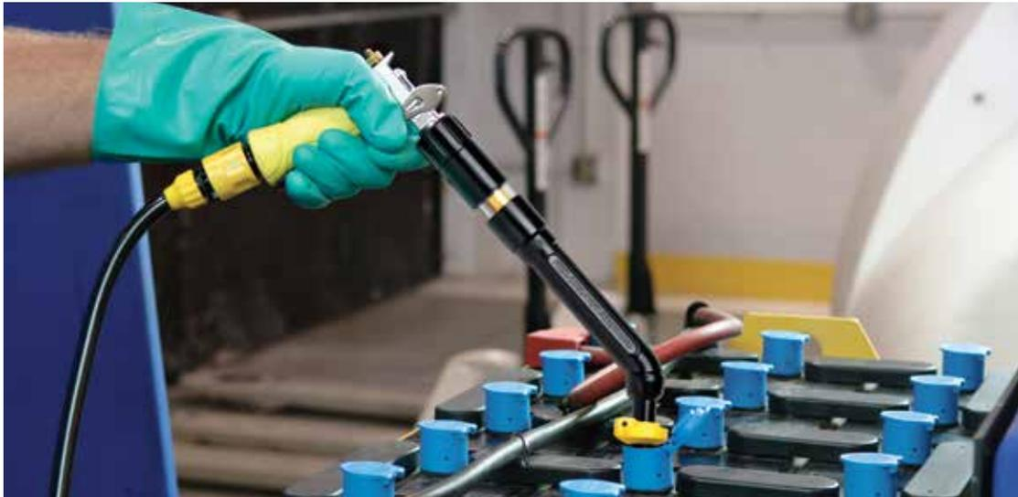
La pistola de riego para baterías (Modelo: GUN-X) está diseñada ergonómicamente con una manija de fácil presión resistente y una boquilla con una inclinación de 45°. El nuevo diseño requiere de una menor inclinación para llenar la batería.
