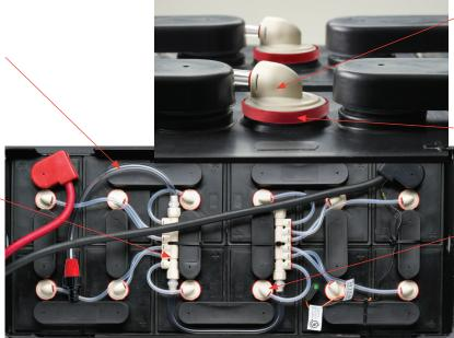
Calibre baixo reduz o risco de danos causados pelos cabos da bateria (21 mm ou 0,83 pol).
