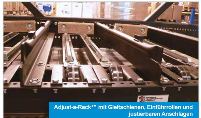
Adjust-a-Rack™ mit Gleitschienen, Einführrollen und justierbaren Anschlüssen
